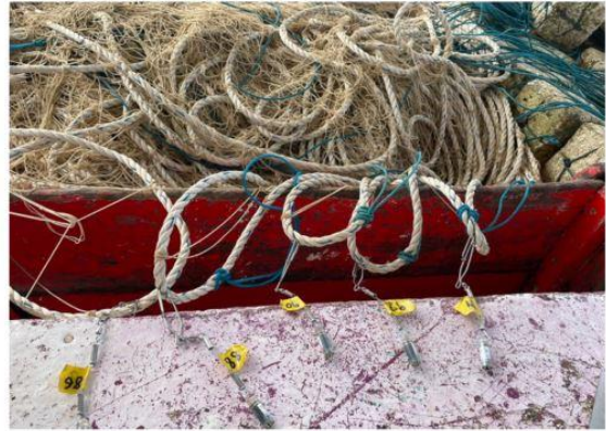
Test de réduction du profil vertical et ses capteurs de profondeur
