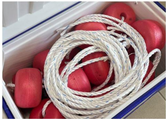
Flotteurs expérimentaux permettant la suppression des ralingues
