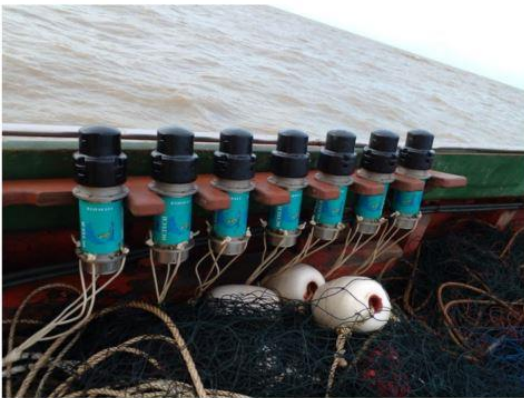
Test des signaleurs acoustiques
